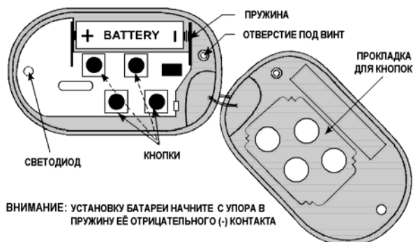
Рисунок 2. Вид изнутри со снятой крышкой
