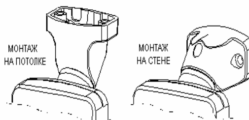
Рисунок 5. Крепление кронштейна на потолок и на стену
