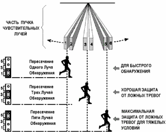
Рисунок 4. Установка счетчика импульсов.
