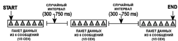
Рисунок А-2. Последовательность для защиты от наложений
