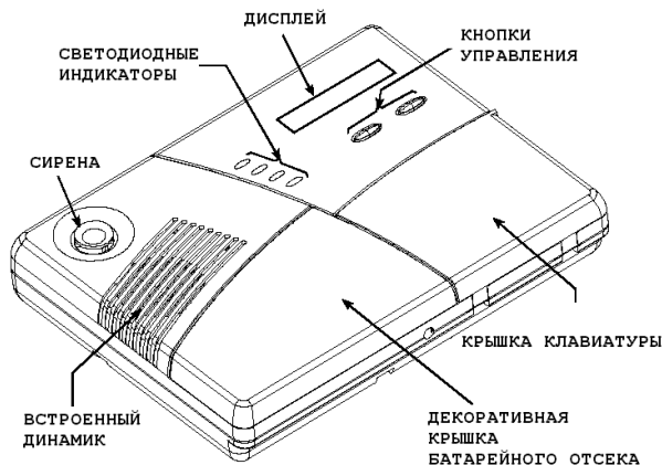
Рисунок 1. Панель управления (с закрытой крышкой)
